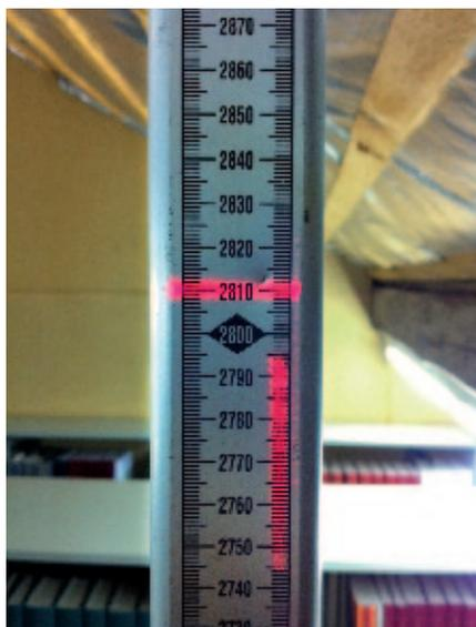
Fig. 11 – Système de lasérométrie mis en place pour surveiller la stabilité de la dalle du 2<sup>e</sup> étage de l'Avenue Jomini 16
