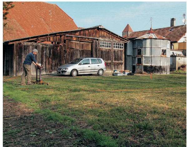
872 Geoelektrische Prospektion im Garten der Parzelle Nr. 843 (Bereich Teilstück PO–T34_M1) (Prospektion 2016.04).
