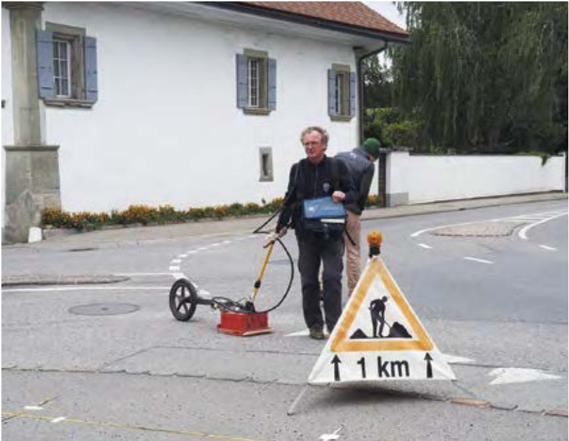
Fig. 46 2016.08. Donatyre / mur d’enceinte. Ch. Hübner effectue des mesures par géoradar au centre du village de Donatyre.
