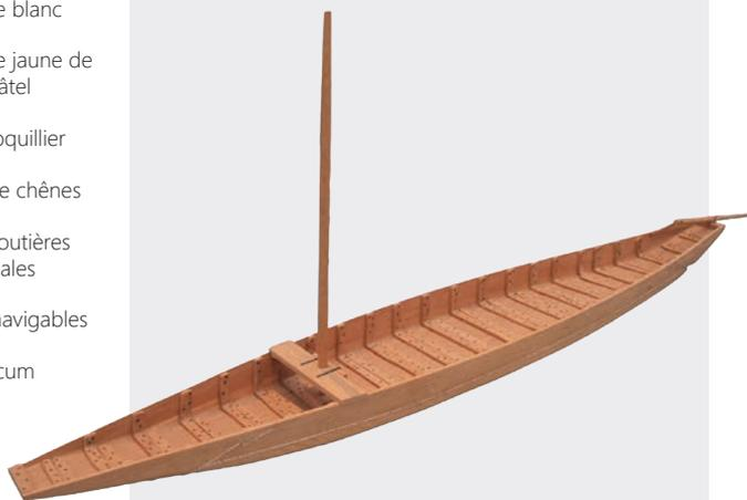
Maquette d'un bateau de transport antique (barge), construite d'après une épave découverte dans le lac de Neuchâtel. Ces embarcations à fond plat se distinguent par leur importante charge utile.
