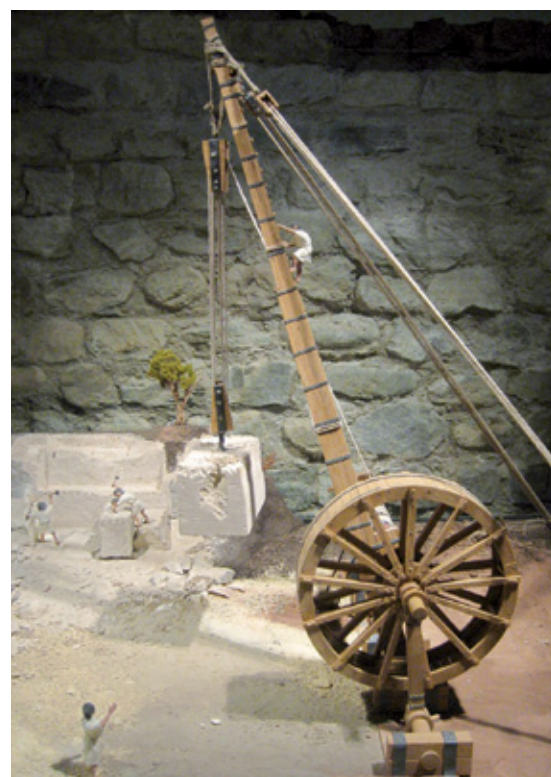
Engin de levage à « cage d'écureuil » utilisé dans une carrière antique
